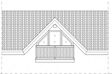
ESEMPIO DI TIPOLOGIA DI ABBAINO CON INSERIMENTO DI BALCONE CON PARAPETTO IN FERRO BATTUTO
