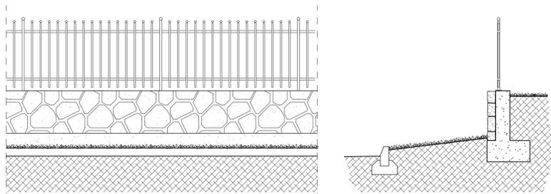
ESEMPIO DI TIPOLOGIA DI RECINZIONE IN FERRO BATTUTO A LAVORAZIONE SEMPLICE SU MURO DI CONTENIMENTO CON PARAMENTO IN PIETRA LOCALE A FACCIA VISTA
